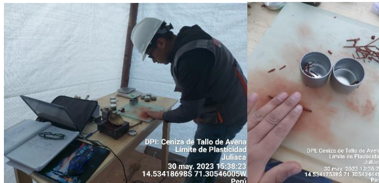
Figura 2. Ensayo de Limites de Consistencia C-1
