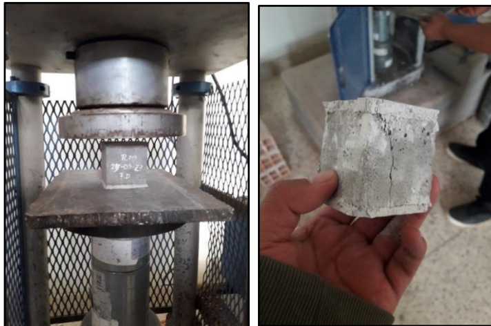
Figura 3. Ensayo de resistencia a compresión cubos de mortero.
