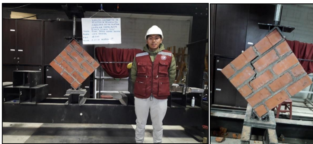
Figura 5. Ensayo de compresión diagonal muretes.
