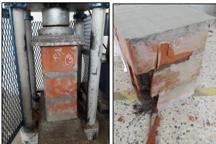
Figura 4. Ensayo de compresión axial en pilas.
